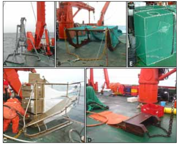
Figura 2. Artes de muestreo utilizados en las campañas BENTART. A, box-corer. B, daga Agassiz. C, trineo suprabentónico. D, draga de roca. E, línea de nasa.
